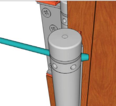
5 Удерживая стержень неподвижным, вставить небольшой стопор в отверстие, ближайшее к крылу петли, которое выступает в роли фиксатора. Медленно повернуть штыри в обратную сторону до тех пор пока стопор не прислонится к крылу петли и вытащить штырь. Повторить данную операцию для пружины, ближайшей к двери, скжав пружину, аналогично первой.
