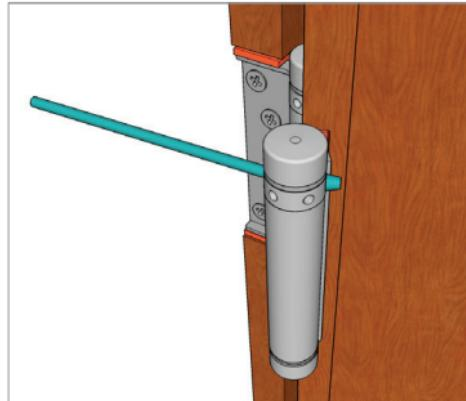
6 Проверить корректную работу петли, в случае необходимости повторить операцию по сжатию пружины несколько раз для достижения уровня сжатия, которое обеспечит самостоятельное закрытие двери. Чем сильнее ската пружина, тем быстрее будет закрываться дверь. Обратите внимание, что дверную пружину можно скать на 7 секторов, что соответствует полному обороту, то есть 360° и еще на 2 уровня свыше этого.
